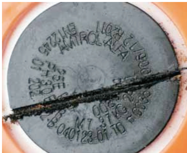
Figure 6 Marquage illisible (niveau 2) – réparable
