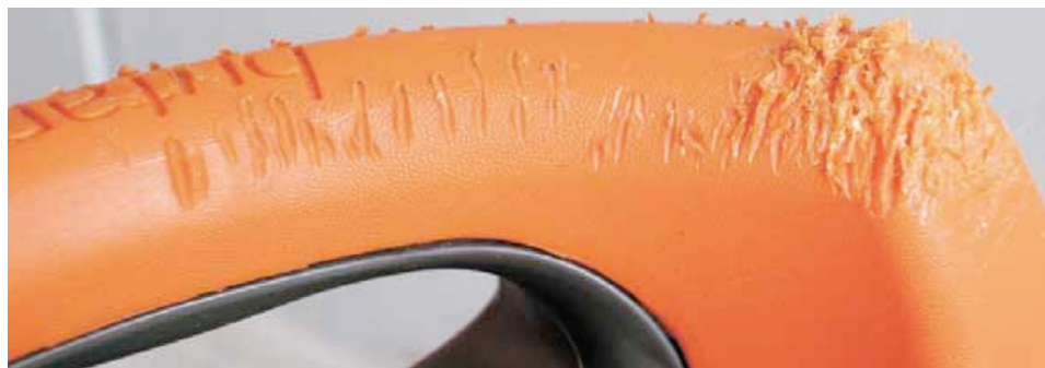
Figure 1b Dommages par abrasion créant un bord coupant pour les mains (niveau 2) – réparable
