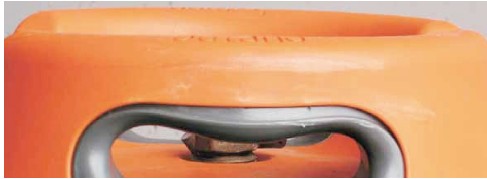
Figure 2a Dommage par impact (niveau 1) – utilisable
