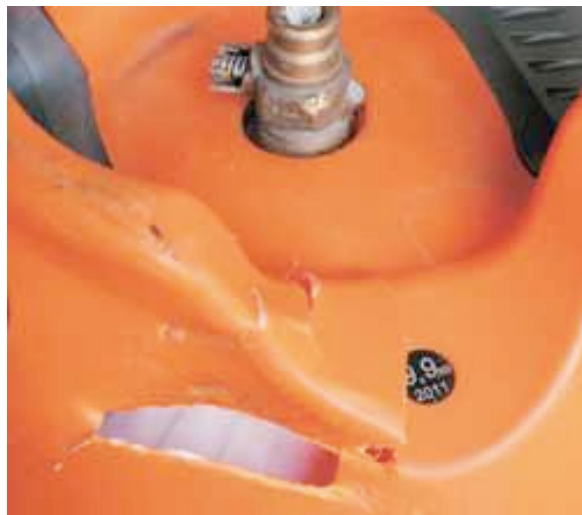
Figure 2c Dommage par impact (niveau 3) créant un dommage par distorsion de la soupape – irréparable
