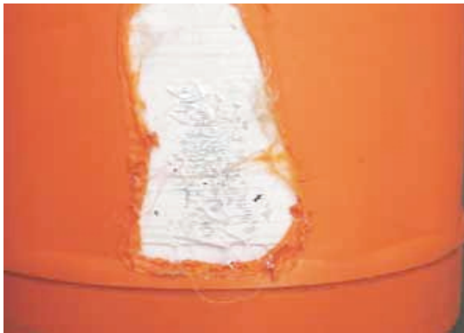
Figure 3b Domage par la chaleur (niveau 3) – irréparable
