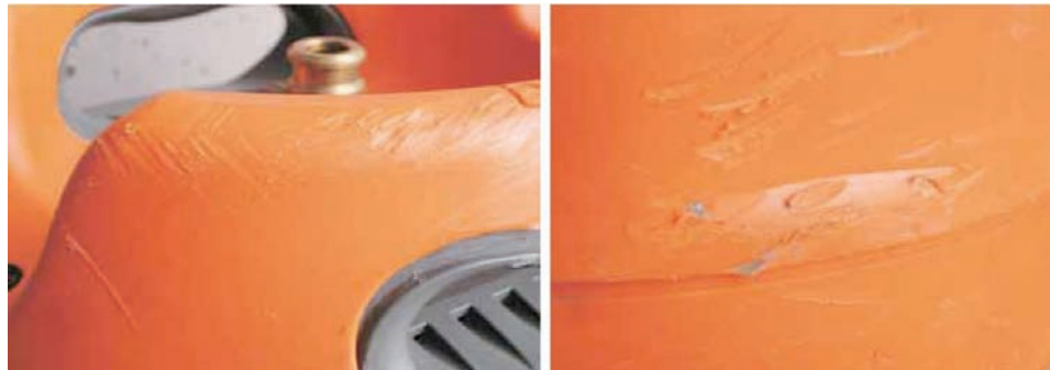
Figure 1a Dommages par abrasion (niveau 1) – utilisable
