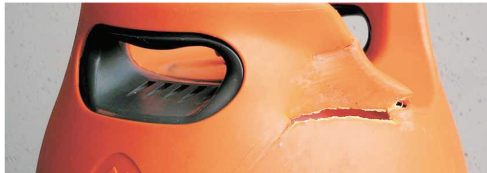
Figure 2b Dommage par impact (niveau 2) – réparable
